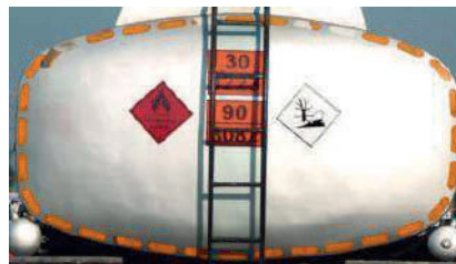
Camion-citerne transportant une matière inflammable et polluante.
